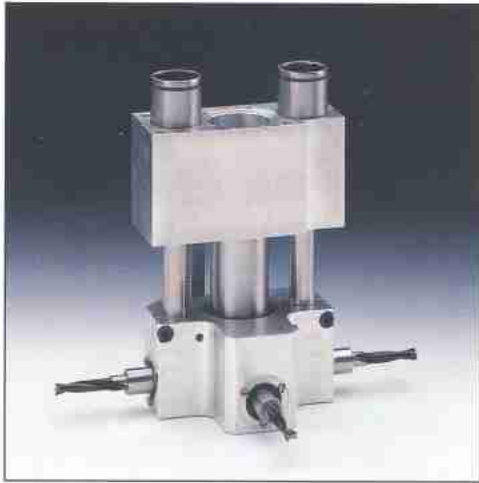
Horizontal-Winkelgetriebe mit dreiseitigem Spindelaustritt für Bohrungen in den Stirnkanten und in einer Längsseite.
