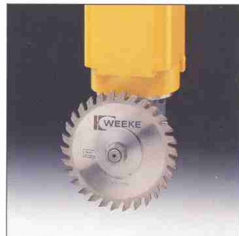
Nutsägeaggregat, Nutsäge 150 mm \varnothing , für ein- und aussetzende Nutzung in X-Richtung. Alternativ kann eine automatische Schwenkung um 90 Grad (für X/Y-Richtung) eingesetzt werden.
