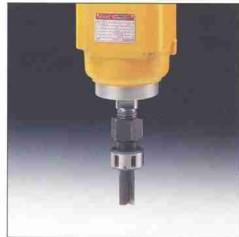
Oberfräs-Aggregat (4,0 kW) mit stufenloser Drehzahlregelung (6000 – 18000 UpM) Werkzeugaufnahme MK 2 oder Spannzange.
