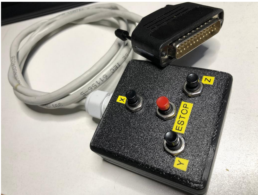
Boîtier de simulation des capteurs fin de course et de l'arrêt d'urgence
